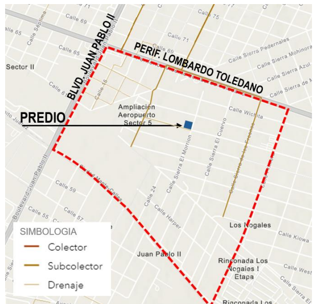
RED DE ALCANTARILLADO SANITARIO EN LA ZONA
