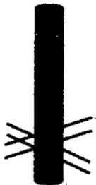
Barra ahogada con anclas de 35 cm de largo cruzadas en sus extremos
