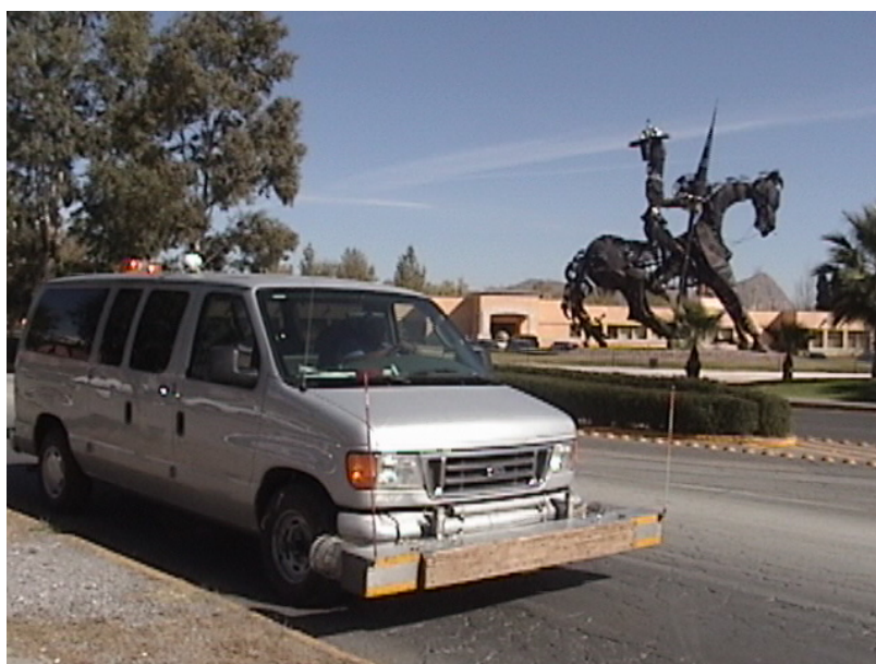
Figura 3.16 Perfilómetro láser, modelo RSP 5051 Mark II
